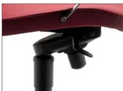
**BASCULANT** : le mécanisme basculant permet l'inclinaison du dossier en maintenant un angle constant entre assise et dossier. Réglage de la hauteur de l'assise par manette pour un réglage optimal de l'utilisateur. Réglage de l'inclinaison du dossier jusqu'à un angle de 13,5°, fixé dans la position souhaitée en actionnant la manette vers le bas. Réglage de la dureté de l'inclinaison du dossier, c'est-à-dire, la force pour le mouvoir.
