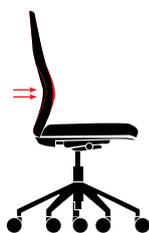
Beaucoup des sièges sont conçus pour tenir un appui adaptable dans le dos. Il est très conseillé que le dossier règle les mouvements avant et arrière, et est possible son blocage selon l'utilisateur. De plus, beaucoup de sièges incorporent un dispositif que règle la courbure de la siège au dos et donne un meilleur repos pour l'employé.
